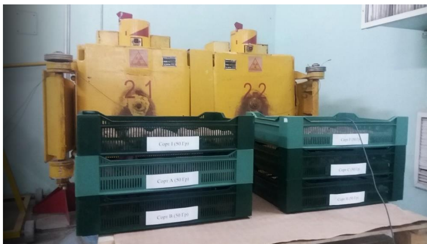
Рисунок 4 – Облучение овощной продукции на гамма-установке ГУР-120
